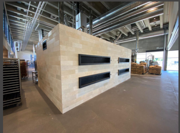
Belader entwickelt für AGR - Holzbacköfen mit integriertem Ascheabsaugsystem.
